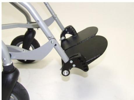
La hauteur maximale de 39 cm est uniquement possible lorsque le repose pied se trouve positionné comme sur la photo.
