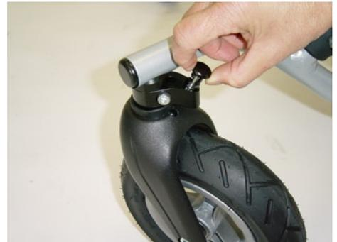
Il est possible de bloquer la roue en serrant la vis latérale.
