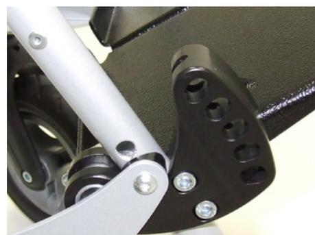
Pour cela il faut enlever le support repose pied du tube et inverser le support gauche et droit.
