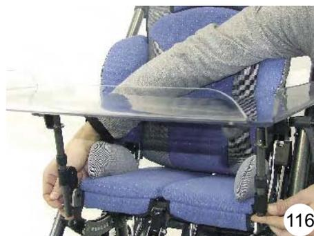
La table est réglable en profondeur et en inclinaison en desserrant les leviers de réglage (A). Sur le modèle réglable en hauteur, on peut en desserrant les vis de réglage (B) ajuster celle-ci.
