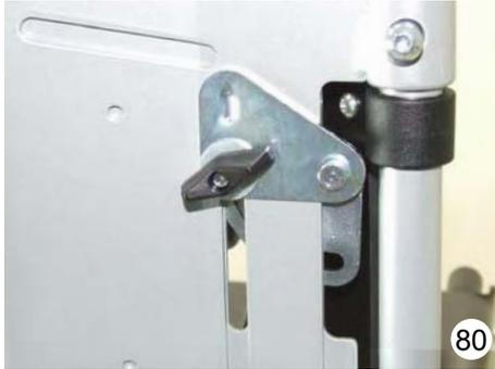
L'encoche du triangle doit se trouver dans le trou oblong. Ensuite mettre la rondelle en place et serrer le papillon.
