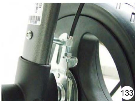
On peut adapter la force du freinage à l'aide la vis e réglage
