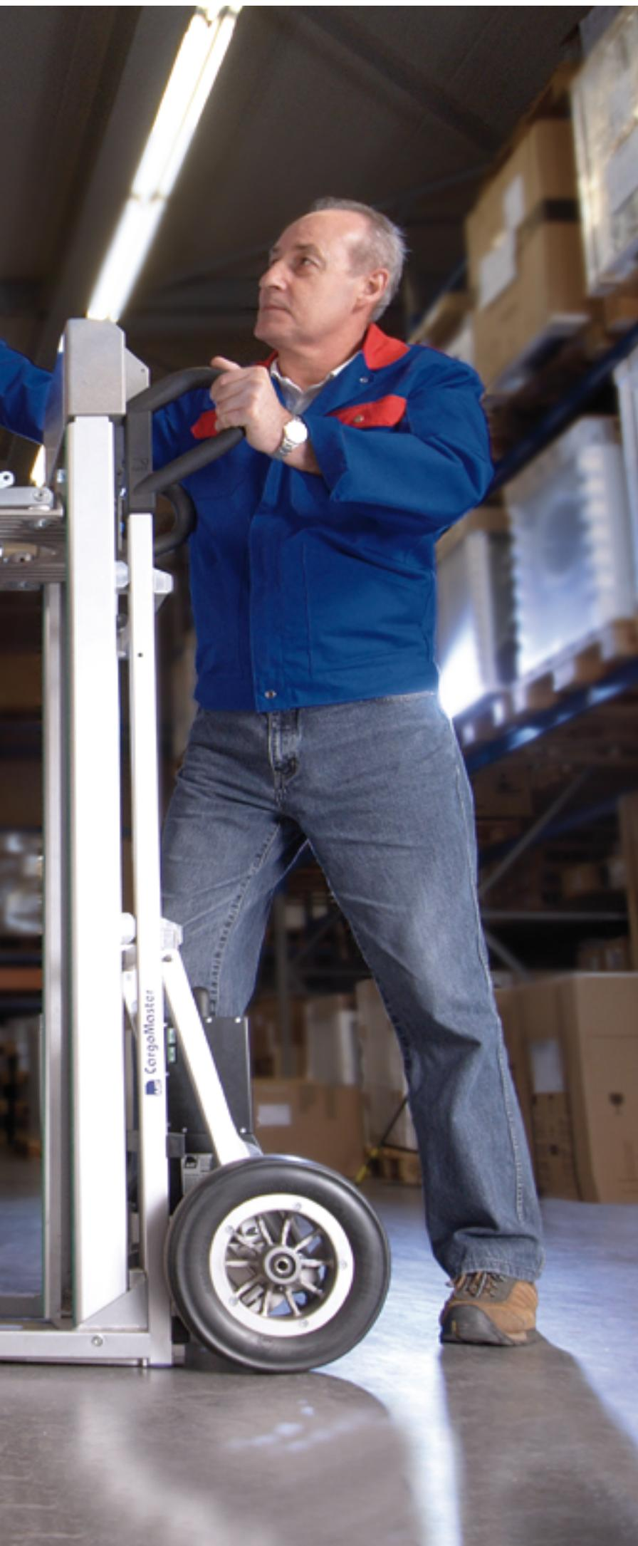
Sur les Cargo Master C Vario, les bras sont télescopiques et réglables en hauteur. Ils peuvent donc être ajustés à la taille de l'opérateur ou à l'exiguïté de la cage d'escaliers.
